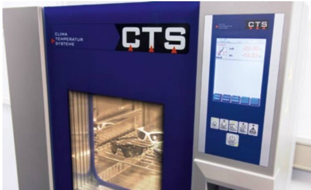
Komora klimatyczna Materiały używane w sprzęcie są czasami narażone na trudne warunki – czy to ekstremalne temperatury, wilgotność, promieniowanie UV czy naprężenia mechaniczne. uvex poddaje wszystkie okulary kompleksowym testom materiałowym w komorze klimatycznej, aby nasze produkty były gotowe do wprowadzenia na rynek.
